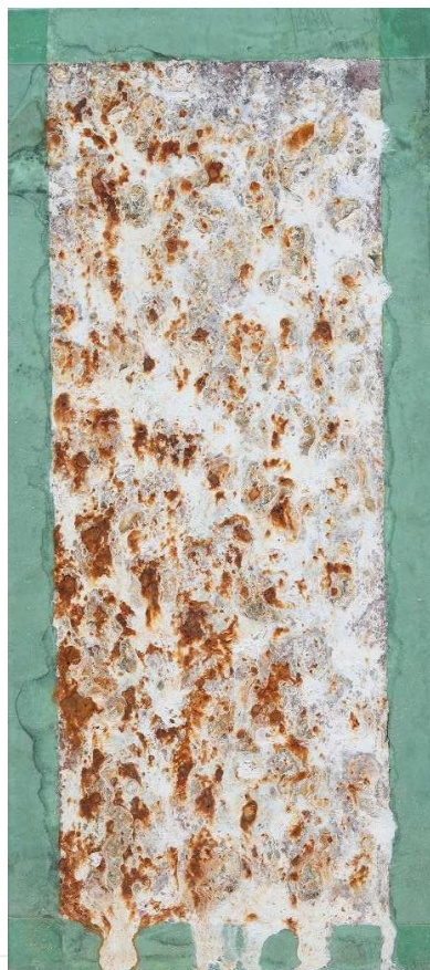
CASS:264時間 磨き銅板 熔融亜鉛メッキ(350g/m 2 )
